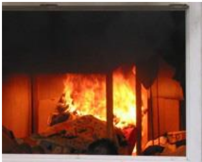
Kinderzimmerbrand nach 2 Minuten:
